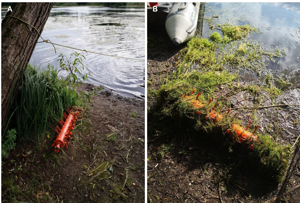
Fotografia 41A-B. Usuwanie moczarki delikatnej przy użyciu walca hakującego z zębami wygiętymi w różnych kierunkach i zbiór roślin z toni wodnej (fot. Ł. Bryl).
