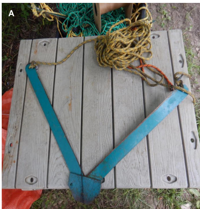
Fotografia 37A-B. Dwa typy kos z ostrzami w kształcie litery V stosowane do wycinania roślin (fot. A – M. Gąbka, B – M. Draga).
