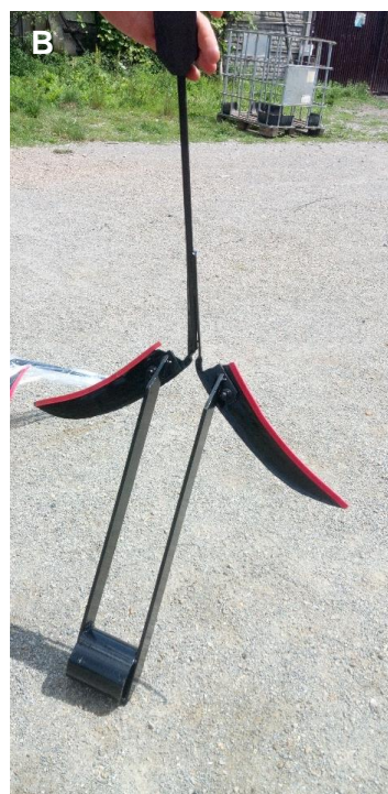
Fotografia 37A-B. Dwa typy kos z ostrzami w kształcie litery V stosowane do wycinania roślin (fot. A – M. Gąbka, B – M. Draga).
