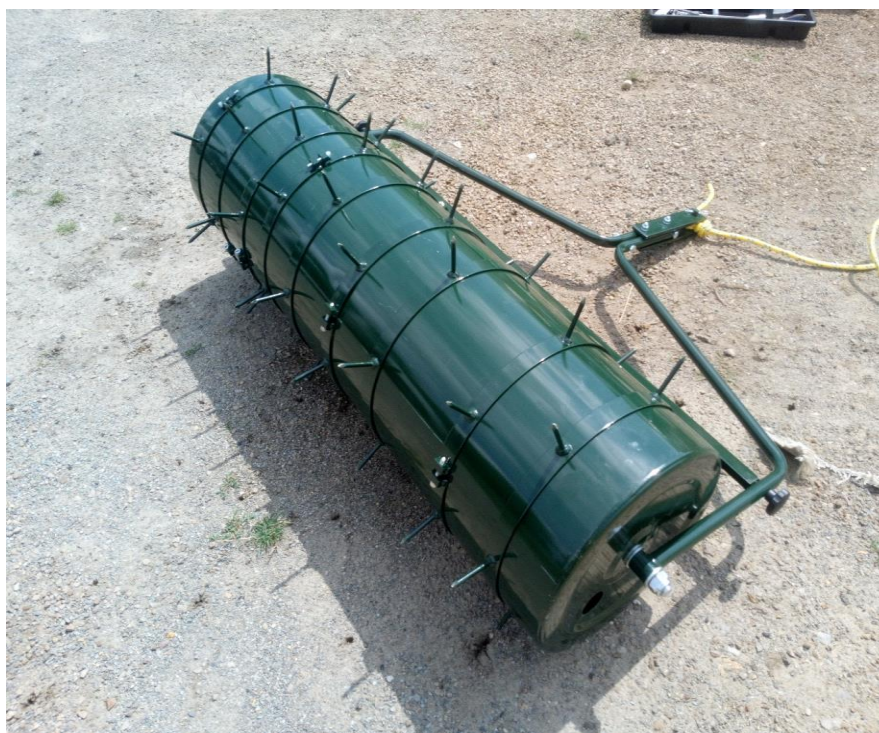
Fotografia 40. Walec hakujący z kolcami prostymi stosowany do usuwania pędów zakorzenionych w dnie (fot. M. Draga).
